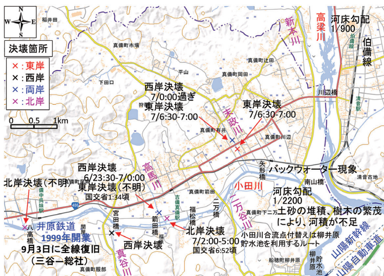
図4 真備町における堤防決壊の状況との河川・鉄道等の情報
