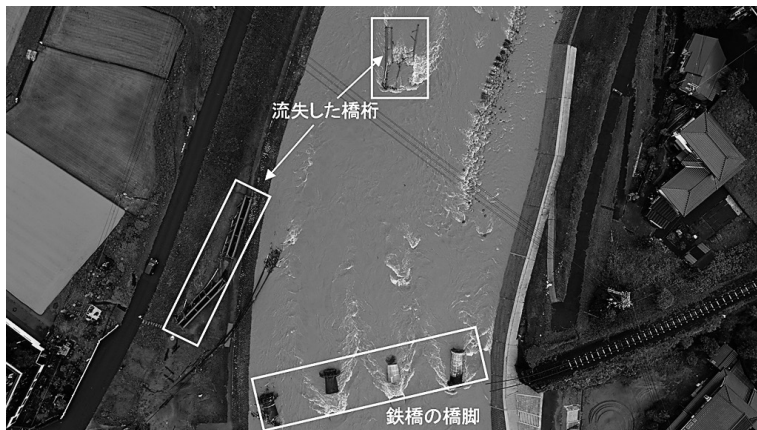
図4 花月川に架かるJR久大本線の鉄橋流失箇所(2017年7月6日 UAVによる撮影)
