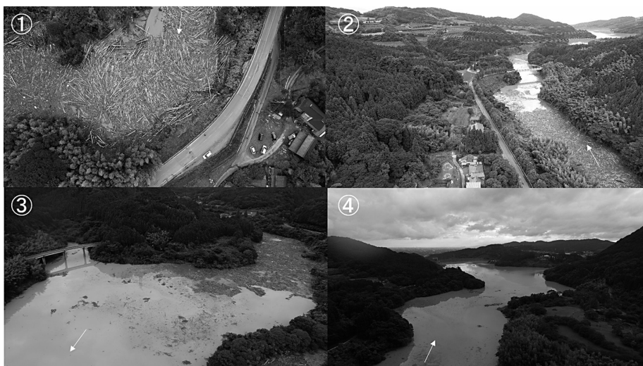
写真5 寺内ダムの流木状況 (①流入蛇行部, ②③流入部, ④ダム本湖)
