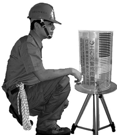
図3 簡易雨量筒による防災専門員の雨量観測
