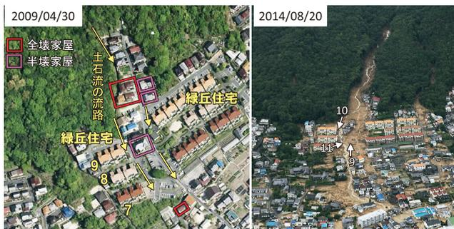
写真8 写真6(2009(平成21)年4月,左)と今回の土石流災害直後(8月20日,右)に国際航業(株)により撮影された空中写真の比較(右の写真中の番号は、写真9~11の撮影場所を示す)
