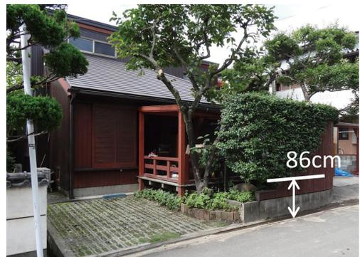
写真6 床上浸水した家屋(浸水深: 86cm, 撮影日: 2012年7月8日)
