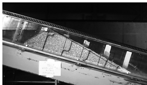
図 2.7 天然ダムのすべり破壊 (供給流量一定)
