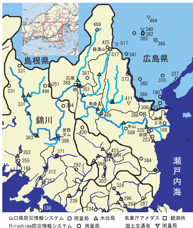
図6 山口県東部と広島県南西部における2005年9月5日12時～7日12時(48時間)の降水分布(広島県の横川(556mm), もみのき(487mm), 田吹(458mm)は、地図外の北東部分に位置する)
