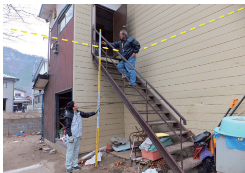
(a) 清水川・小本川合流付近の浸水深3.51 m
