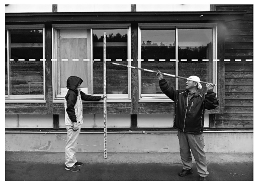
(d) 浸水した道の駅・浸水深2.30 m : 筆者撮影
