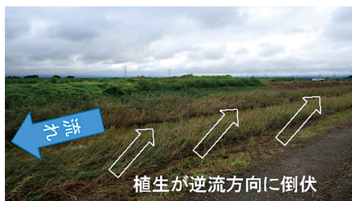
Fig. 9 植生の逆流方向への倒伏
