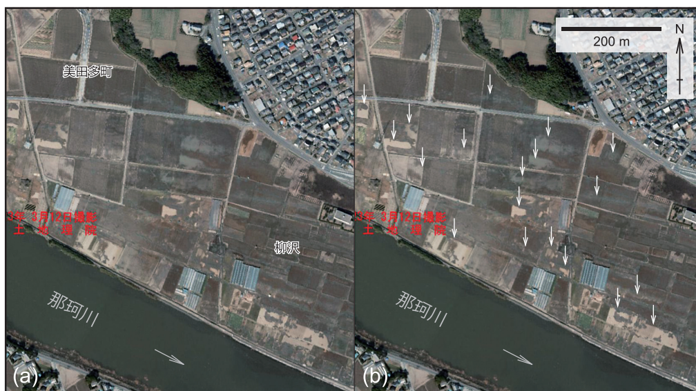
図9 ひたちなか市美田多町～柳沢付近の変状。(a)は3月12日撮影空中写真のオルソ画像 15) であり、(b)は液状化に起因すると判断される変状を矢印で記入したもの。
