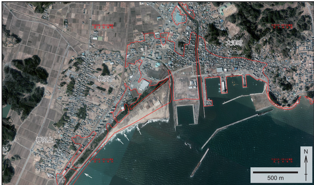
図5 北茨城市関南町神岡上～大津町付近の浸水域。背景は3月12日撮影空中写真のオルソ画像 15) 。矢印は津波が浜堤を乗り越えて浸入したと推定される地点。
